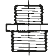
Nippel, reduziert, mit Außengewinde.
