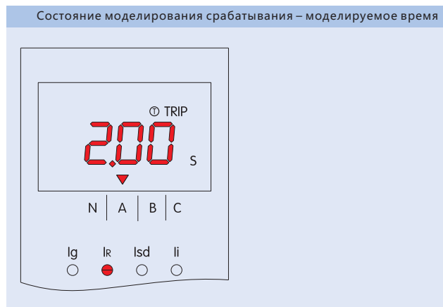
Состояние моделирования срабатывания – моделируемое время
