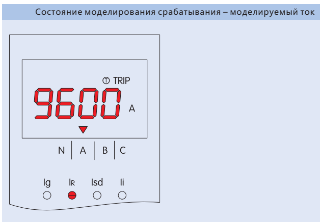
Состояние моделирования срабатывания – моделируемый ток
