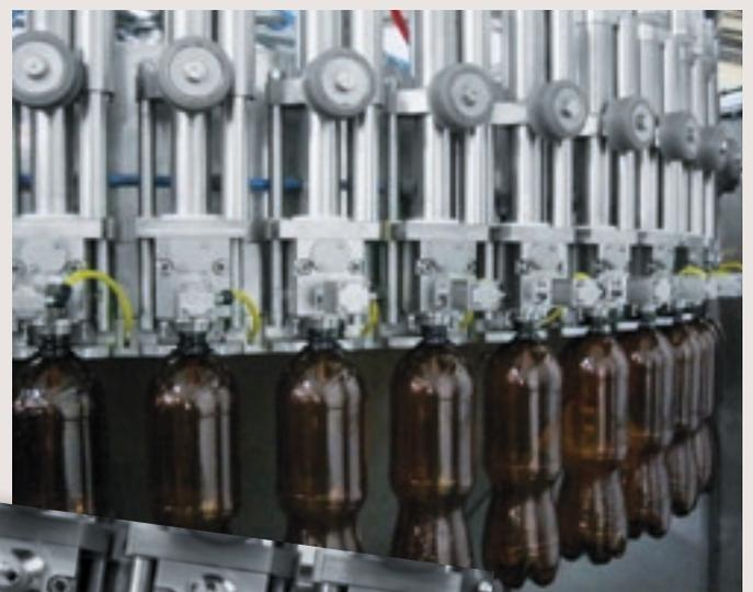
Per i prodotti che sono **sensibili all'ossigeno**, con la "GranPrix" è possibile effettuare un lavaggio completo delle bottiglie con gas inerte direttamente dall'anello superiore riducendo in maniera consistente la quantità di ossigeno prima del riempimento.
