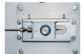
Система натяжения с винтами и болтами (PDL-PDXL).
