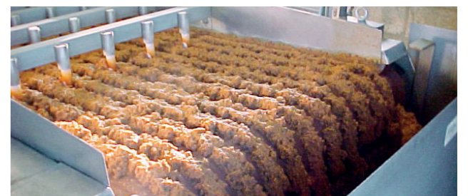
Направляющие элементы для распределения шлама и поддержания процесса обезвоживания.
