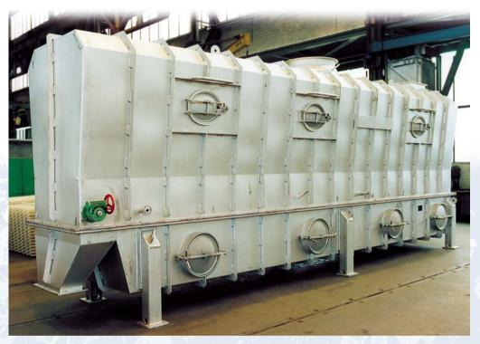
Разработка специальных воздухораспределительных решеток, расположенных под слоем продукта, все больше позволяет отказаться от вибрации аппарата и тем самым остановиться на применении неподвижного, а значит и не требующего большого технического обслуживания, аппарата. Именно поэтому неподвижно закрепленные аппараты являются более гибкими при расчете габаритных размеров.
