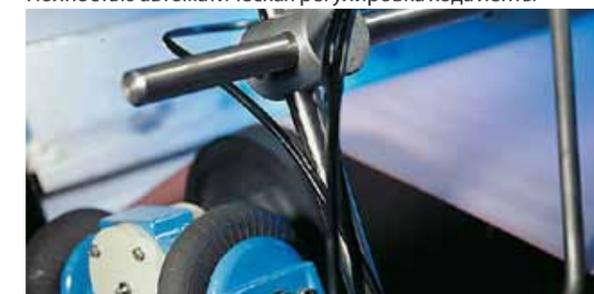
Опция: Натяжение ленты с помощью пневматических цилиндров
