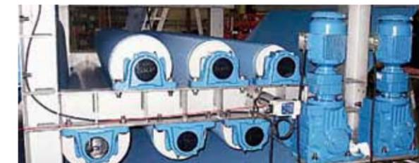
Полностью автоматическая регулировка хода ленты
