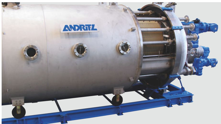
Барабанный напорный фильтр TDF Krauss-Maffei с площадью фильтрации 16 м 2
