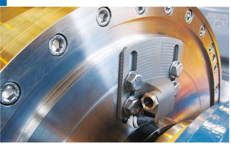
АNDRITZ SEPARATION разработал новое поколение устройств вывода жидкой фазы- TurboJet-которое существенно, до 30%, сокращает энергопотребление. Патентованное устройство ТurboJet производит разгрузку жидкой фазы в противоположном к вращению барабана направлении. Форма данного устройства аналогична соплам реактивного двигателя. Дополнительная реактивная сила, возникающая при выбросе жидкой фазы из барабана, существенно снижает энергопотребление.
