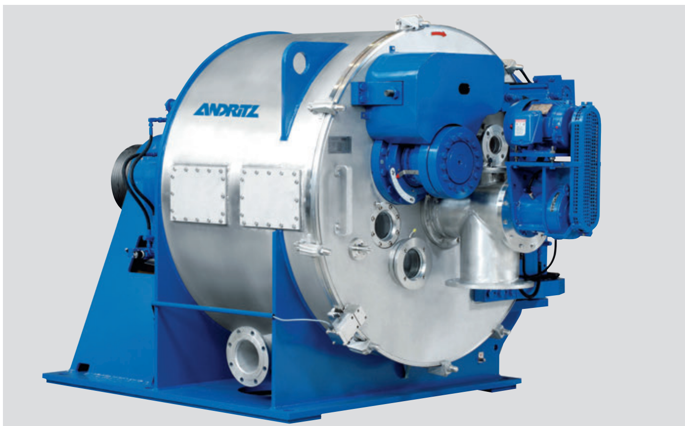
Горизонтальная центрифуга с ножевым съёмом HZ 125/3,2 Si
