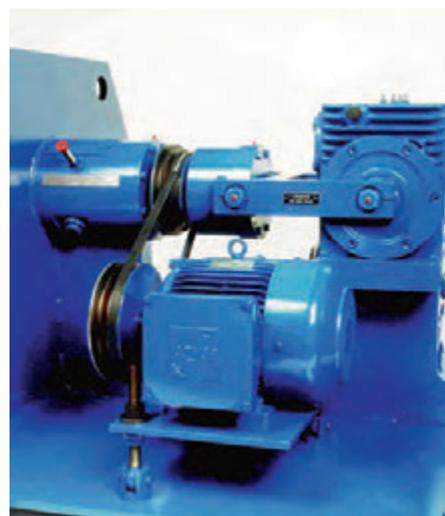
Механический привод пульсаций
