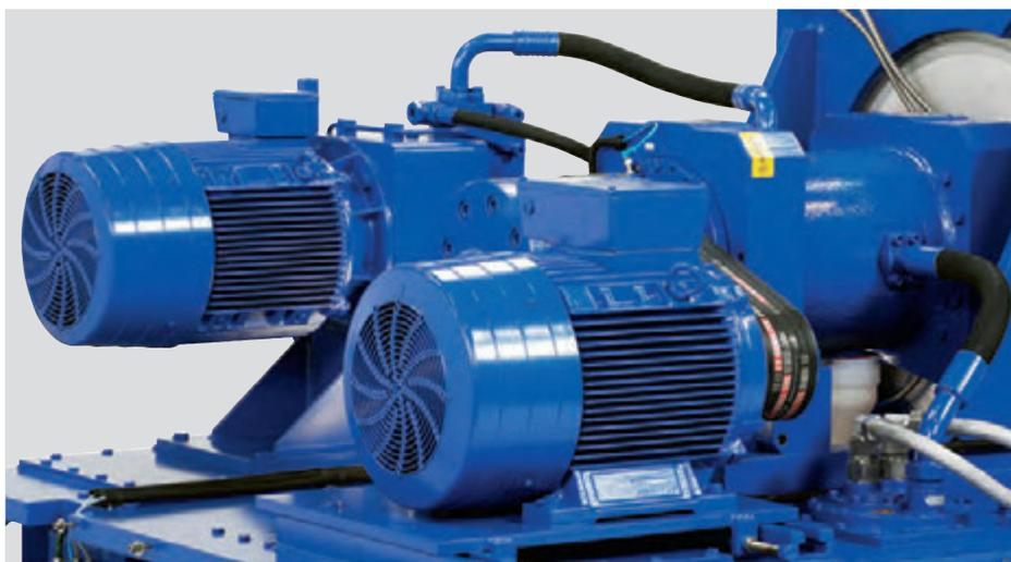
Гидравлический привод пульсаций
