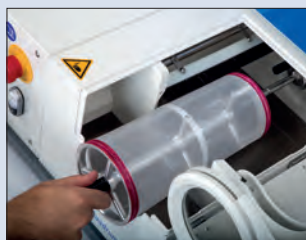
Упрощённое извлечение круглого сита
