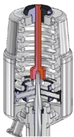
Привод, функция управления 1 нормально закрытый пружиной (NC)
