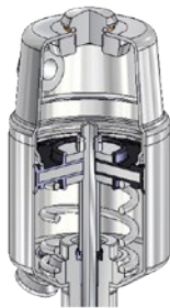
Привод, функция управления 2 нормально открытый пружиной (NO)
