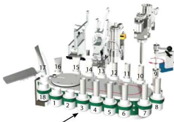
Система запайки пластиковых туб горячим воздухом
