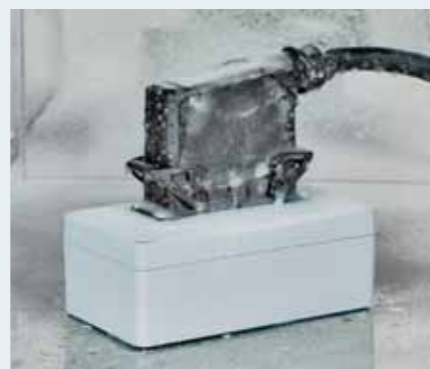
Блочный разъем HEAVYCON EVO в климатической камере при -50°C
