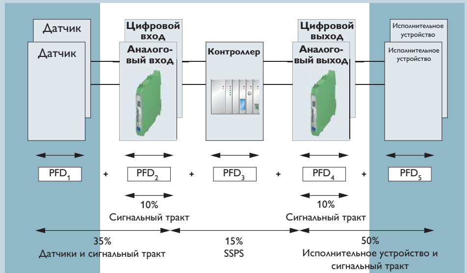
Возможное распределение PFD-значений вероятности отказа в цепи системы, относящейся к технике безопасности.
