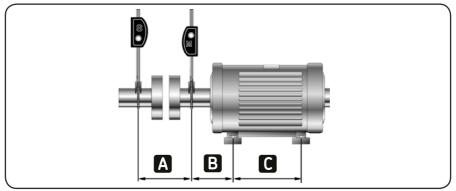
Fig. 14. Machine dimensions
