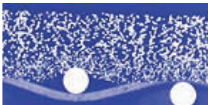
Вид в поперечном разрезе – волокно из нержавеющей стали код -3SF (и поддерживающая металлическая сетка)
