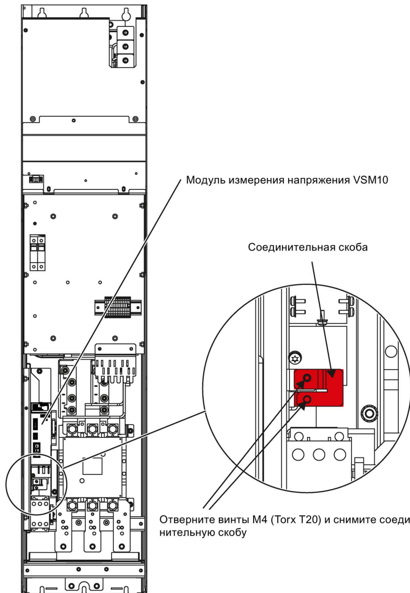
Рисунок 3-23 Удаление соединительной скобы к модулю базового подавления помех в активном интерфейсном модуле для типоразмера G1
