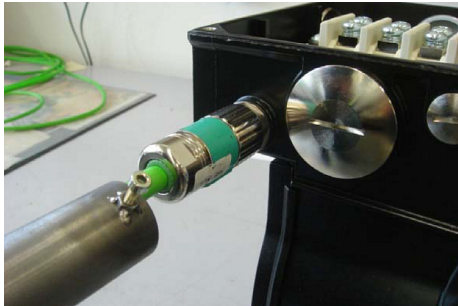
Изображени Наденьте защитную трубку на сигнальный штекер е 6-6
