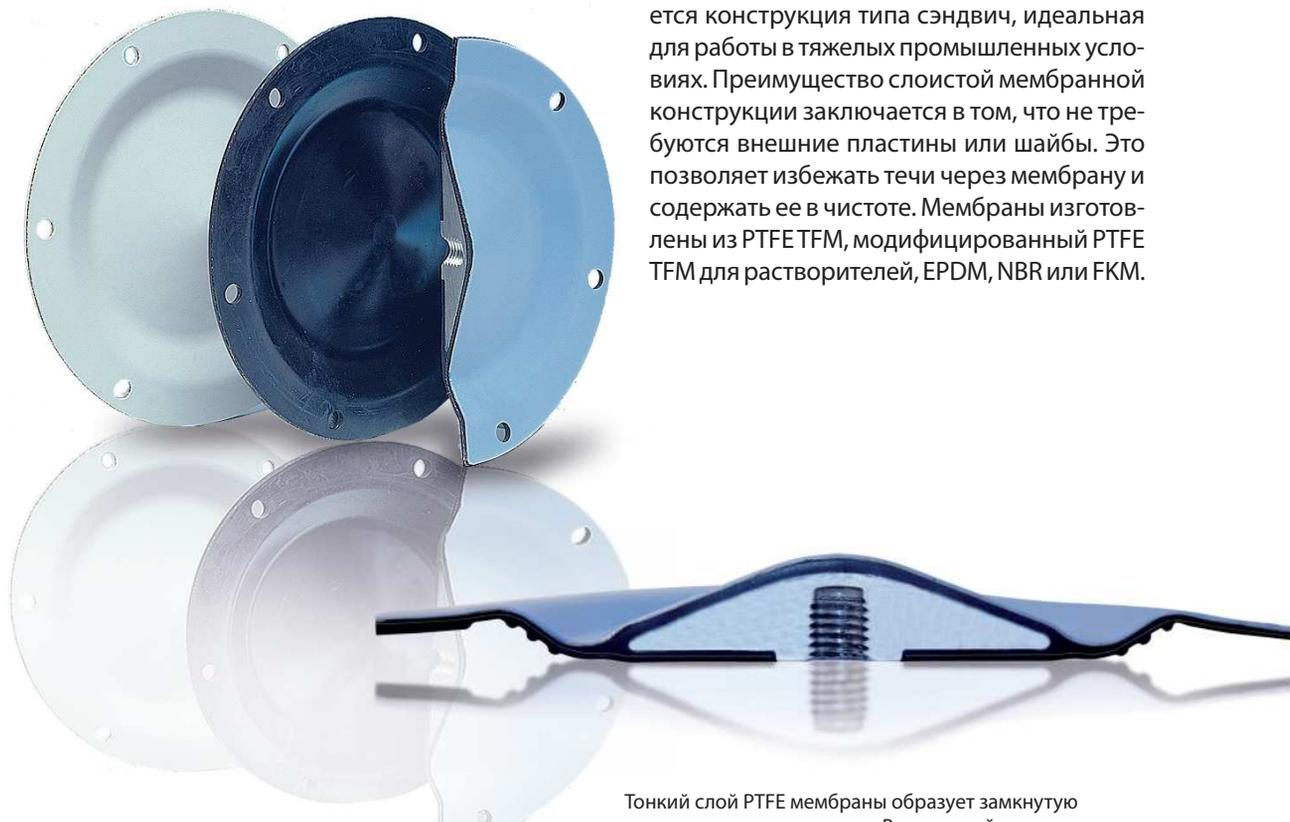
Тонкий слой PTFE мембраны образует замкнутую поверхность для жидкости. Встроенный вспомогательный сердечник из легкого металла и армированная ткань соответствуют высоким требованиям к износостойкости.
