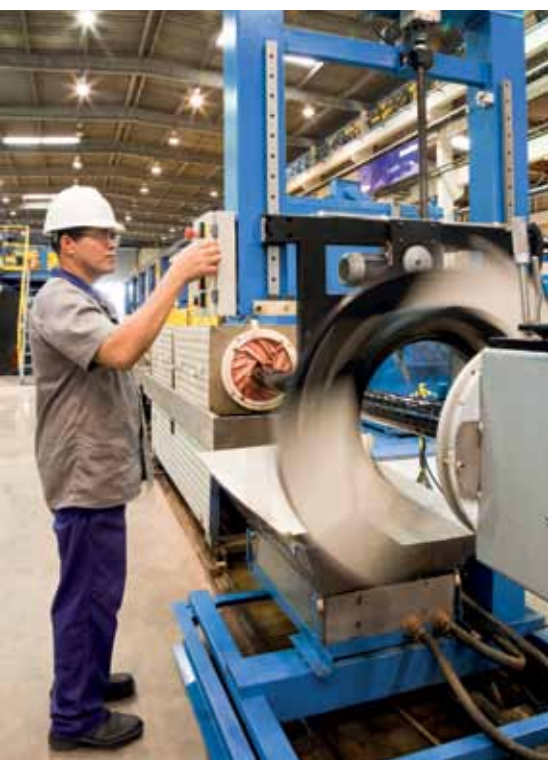
▼ Extrusão de capa termoplástica na fábrica da MFX / Thermoplastic jacket extrusion at MFX plant
