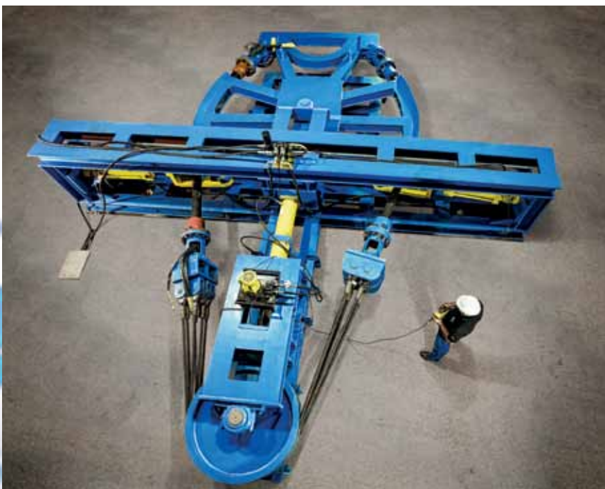
► Teste cíclico no laboratório da MFX / Installation cyclic test at MFX umbilical lab
