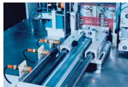
Датчик переключается при достижении магнитом порога точки переключения. Например, тип M18 обнаруживает диапазон до 70 мм.
