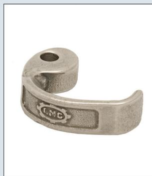
Погнувшаяся ручка, изготовленная методом точного литья компании LMC.
