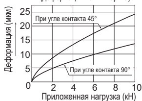
Рис.2 Радиальная нагрузка и деформация (обычный зазор, без предварительного натяга)
