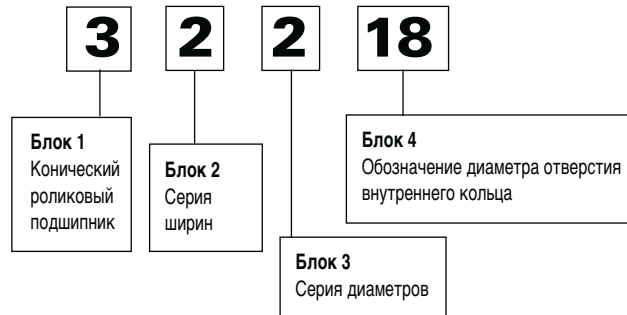
Рис. 30. Оригинальная система обозначений ISO.
