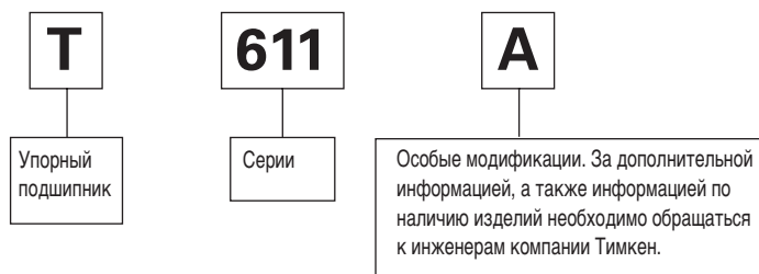
Рис. 41. Система обозначений упорных конических подшипников.
