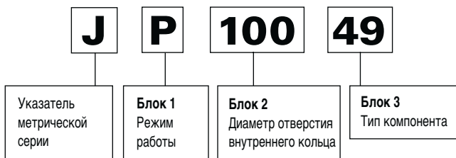
Рис. 28. Номенклатура системы обозначений с префиксом «J».
