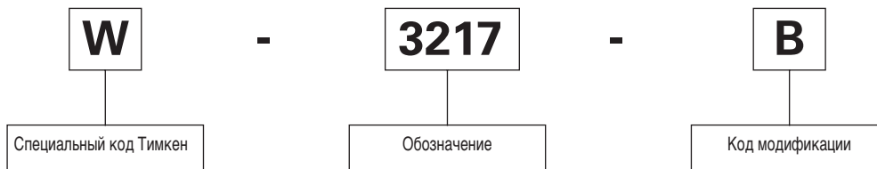
Рис. 42. Система обозначений специальных подшипников.
