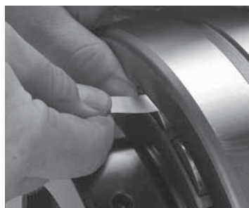
Рис. 18. Измерение РВЗ до монтажа.
