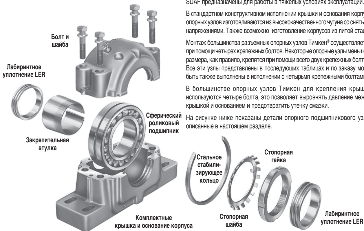
Рис. 26. Опорный узел сферического роликового подшипника Тимкен в разобранном виде: сферический роликовый подшипник с коническим отверстием, закрепительная втулка, стопорная гайка, стопорная шайба, стабилизирующее кольцо и трехкольцевое лабиринтное уплотнение. Кроме того, на рисунке показаны выемки в крышке и основании, образующие инструментальный паз, а также интегрированные установочные осевые элементы основания и крышки.
