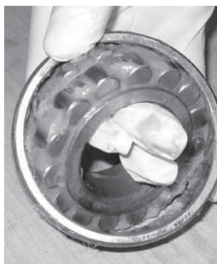
Рис. 21. Пластичная смазка позволяет легко заправить подшипник вручную.
